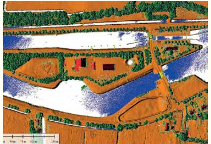
Detail rondom de sluis in de Hoogeveensche vaart bij Rogat. Gekeurde locaties zijn gemeten door het vliegtuig. Oranje: maaiveld, blauw: water, geel: kunstwerken, rood: bebouwing, groen: vegetatie en overig, wit: no-data.
